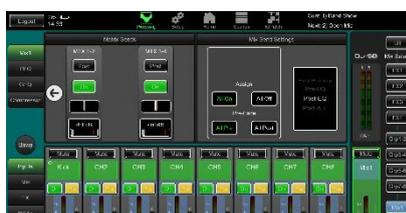
Utilizzate la tab Mix nella schermata **Processing** e toccate la freccia a destra per visualizzare le opzioni di routing. Potete impostare velocemente un punto di partenza con tutti i settaggi on / off e pre / post per ogni mix.
