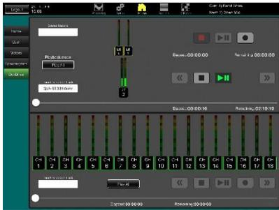
**Registrazione diretta Qu-Drive su drive USB** – Potete effettuare registrazioni stereo o multitraccia a 18 tracce direttamente su un dispositivo di memorizzazione USB collegato alla porta Qu-Drive presente sul pannello frontale. Per maggiori informazioni sull'uso di dispositivi USB, consultate il documento 'Understanding Qu-Drive and USB' nella sezione Qu Knowledgebase sul sito Allen & Heath. Utilizzate il dispositivo USB esclusivamente con il mixer Qu e non per altre applicazioni.
