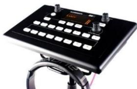
Se state utilizzando il sistema ME Personal Mixing Allen & Heath, collegatelo alla porta dSNAKE, EXPANDER o MONITOR (solo AR2412). I mixer ME-1 possono essere collegati in serie oppure individualmente attraverso l'hub ME-U PoE Allen & Heath.
