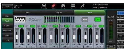
**Automatic Mic Mixing (AMM)** – Questa funzione è molto utile in applicazioni come conferenze e seminari in cui vengono impiegati numerosi microfoni intorno a un tavolo. La funzione AMM rileva automaticamente il livello di questi microfoni per migliorare l'udibilità e ridurre il rischio di feedback causato dall'apertura simultanea dei vari microfoni.
