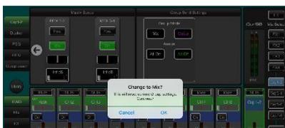
**Impostazione dei Group** – Possono essere configurati come sottogruppi audio o mix stereo aggiuntivi, per esempio se si lavora con molti monitor in-ear. Utilizzate la tab Mix della videata **Processing** e toccate la freccia a destra per selezionare la modalità Mix o Group. Se state utilizzando i sottogruppi assegnati a LR, ricordatevi di disattivare l'assegnazione di questi canali al mix LR.
