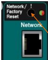
È possibile effettuare un reset completo qualora sia necessario ripristinare completamente le impostazioni e le memorie del mixer Qu. Potrebbe essere necessario effettuare questa operazione prima di inviare il mixer ad un cliente o se si sospettano problemi di sistema.
