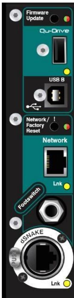
**1 Porta Network** – Qu-SB si controlla via iPad con l'applicazione Qu-Pad di Allen & Heath in esecuzione. Collegate un router wireless (punto di accesso wireless) a questa porta per configurare una rete Wi-Fi per la connessione dell'iPad al mixer. Trovate i dettagli più avanti in questa guida.
