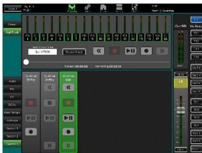
**Utilizzare le Strip Qu-Drive per il controllo del trasferimento** – Potete utilizzare le strip per il controllo del trasferimento Qu-Drive per registrazioni e riproduzioni stereo o multitraccia, per esempio, per armare, avviare e fermare le registrazioni durante il mixaggio. Utilizzate la pagina Strips della videata **Setup** per trascinare le strip sulle tre strip custom disponibili.
