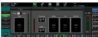
**Channel Ducker** – Potete inserire un ducker sui canali di ingresso o group. Ciò vi permette di utilizzare qualsiasi segnale di Qu per attenuare (duck) automaticamente altri canali attivi. Per esempio: utilizzare un microfono da tavolo come trigger per attenuare la musica di sottofondo.
