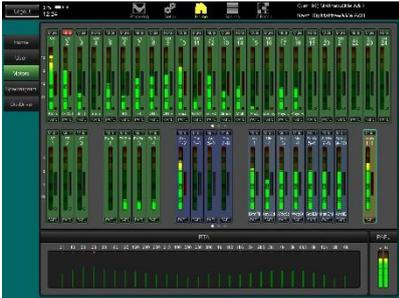
**RTA** – L'analizzatore in tempo reale integrato include uno Spettrogramma che mostra la risposta in frequenza del segnale PAFL selezionato. È utile per rilevare problemi di frequenza in una stanza o quando i monitor vanno in risonanza.
