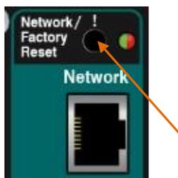
**Indirizzo di rete Qu** – Il mixer deve avere un indirizzo TCP/IP (network) compatibile con il router. L'impostazione predefinita di Qu è DHCP attivo: significa che il router allocherà automaticamente un indirizzo compatibile con il mixer. Se l'indirizzo del mixer è stato variato e la app Qu-Pad non si connette, potete resettare Qu riportandolo alle impostazioni predefinite.
