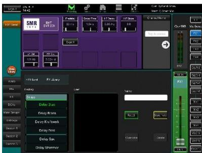
**Impostazione delle mandate Matrix** – Utilizzate la tab MTX della schermata **Processing** per lavorare con i suoi livelli di mandata e routing.
