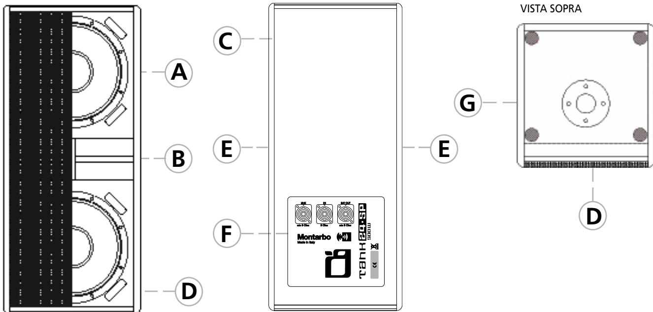
**A** Tank24SP: 2 woofer ad altissima escursione da 12", con magnete al neodimio e bobina ad alta escursione da 2,5", superventilati per minimizzare la 'power compression', accordati da un generoso reflex per permettere alle note gravi di proiettarsi senza compressioni.
