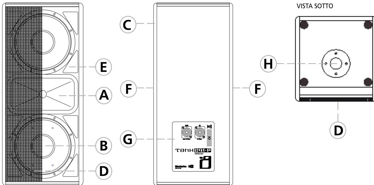
**A** Tank241P - Tank201P: driver a compressione, con gola da 1" e bobina a lunga escursione da 1,4", schermato, caricato a tromba (dispersione 80° H x 60° V).
