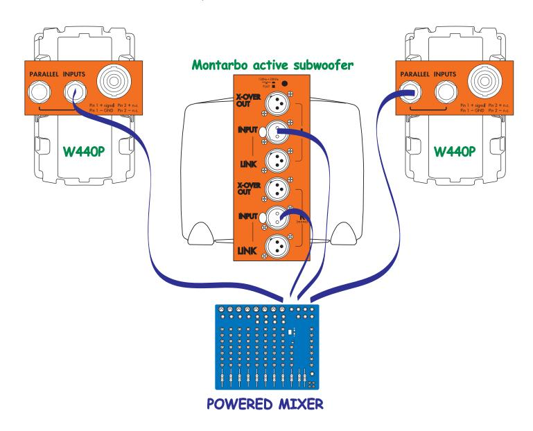
MIXER L/R POWERED OUTPUTS W440P INPUTS
